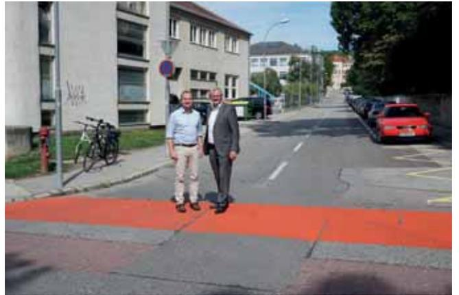
> Am **Kurzwiesenweg** wurden im Sommer Markierungsarbeiten durchgeführt. Am unteren Ende sowie auf Höhe der Bushaltestelle lenken zwei rote Streifen die Aufmerksamkeit auf querende Fußgänger und sorgen so für mehr Sicherheit im Straßenverkehr.
